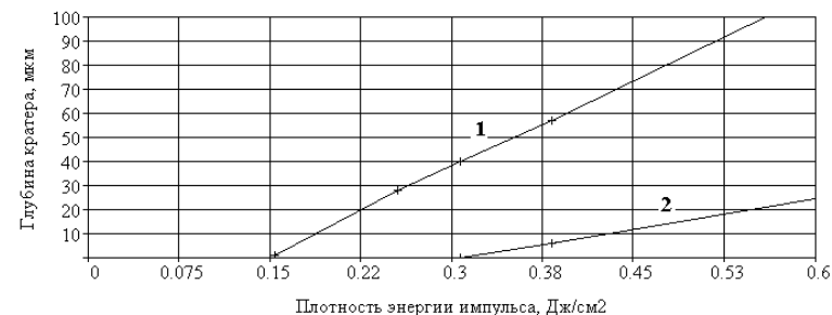
Рис. 4. Зависимость глубины кратера в зубном камне (1) и эмали (2) от плотности энергии (после 1000 импульсов облучения)
