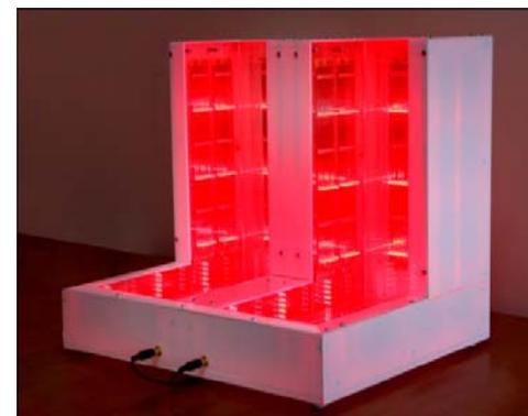
Рис. 1. Двухсекционный аппарат с двумя Г-образными фотонными камерами
