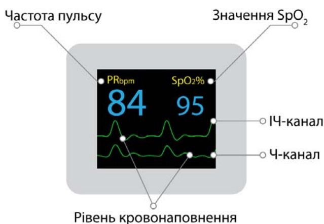
Рис. 2. Відображення інформації на розробленому пристрої
