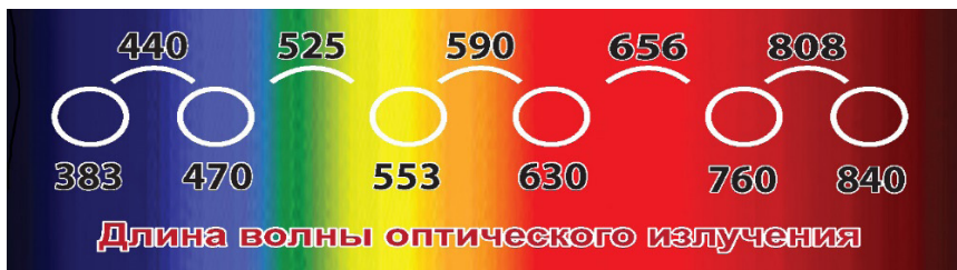
Рис. 1. Базовые спектральные области разработанного измерителя мощности излучения
